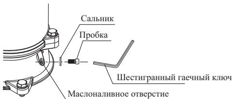
**Примечание:** Удаление отработанного смазочного масла следует осуществлять в соответствии с действующими нормами. Категорически запрещается сливать масло в канализацию или в реку. После контроля и замены смазочного масла замените сальник и уплотнительное кольцо "O-ring".
