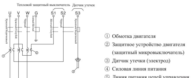
■  $\text{Y} \rightarrow \triangle$  схема пуска звездой треугольником
