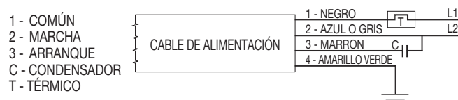
Esquema de conexión eléctrica SUMERGIBLES MONOFÁSICA SEM-PRM-CUTTY
