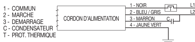
Schéma de branchement électrique IMMERGEES MONOPHASEES SEM-PRM-CUTTY
